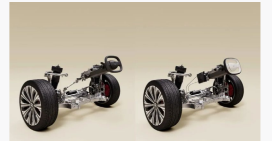
传统机械转向(左)与线控转向(右)对比
