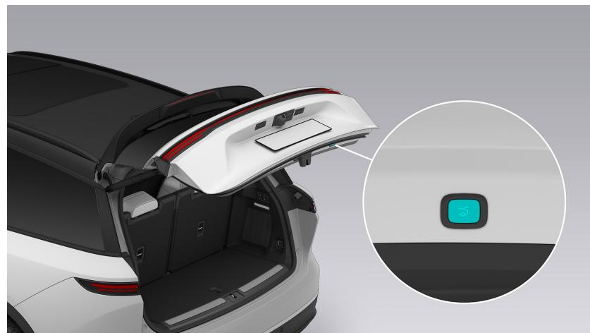
Wenn Sie die an der Innenseite der Heckklappe befindliche Taste drücken, schließt sich die Heckklappe automatisch und rastet hörbar ein.
