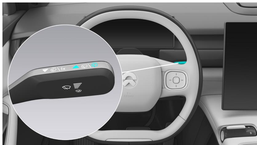
**Sprühen und Wischen mit Heckscheibenwischer:** Halten Sie den Wischerhebel nach vorne gedrückt, um Wasser auf die Heckscheibe zu sprühen, während die Heckscheibenwischer mit niedriger Geschwindigkeit arbeiten. Wenn Sie den Wischerhebel loslassen, wird kein Wasser mehr versprüht, aber die Scheibenwischer wischen noch dreimal langsam.
