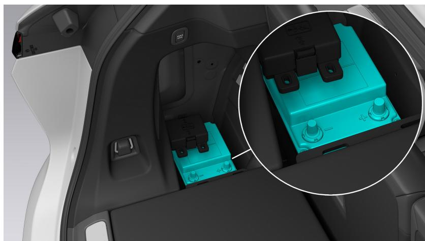
2. Schließen Sie ein Ende der roten Leitung am Pluspol (+) der 12-V-Batterie des entladenen Fahrzeugs A an.
