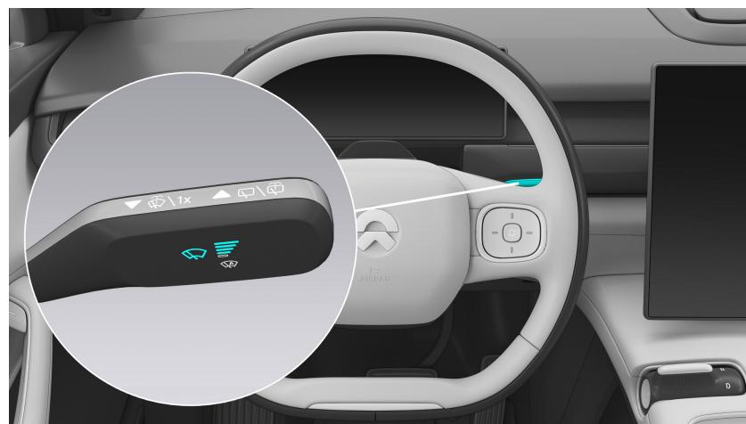
Drücken Sie den Wischerhebel nach oben, um die Scheibenwischer einzuschalten. Die Geschwindigkeit der Scheibenwischer steigt mit jeder Schaltstufe und erreicht ihr Maximum auf Stufe 4. Wird der Wischerhebel wieder in seine Ausgangsstellung gebracht, halten die Scheibenwischer an.
