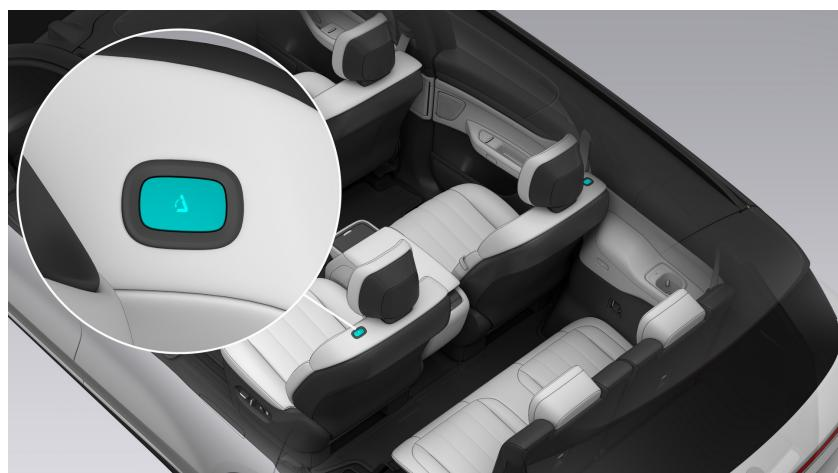
Das Fahrzeug erkennt mithilfe der Belegungserkennung, welche Sitze besetzt sind. Wenn Insassen in der zweiten Sitzreihe sitzen, zeigt das Drücken der Taste keine Wirkung.
