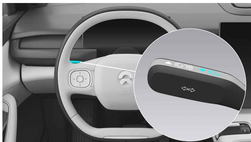
Um das Fernlicht nur einmal kurz aufleuchten zu lassen (Lichthupe), ziehen Sie den Lichtbedienhebel nach hinten und lassen ihn dann los.
