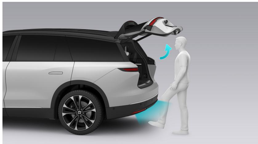
Um die Kicksensor-Funktion der Heckklappe zu aktivieren, öffnen Sie die Einstellungen unten im Center-Display und tippen Sie auf **Verriegelung von Türen und Fenstern > Kicksensor**.
