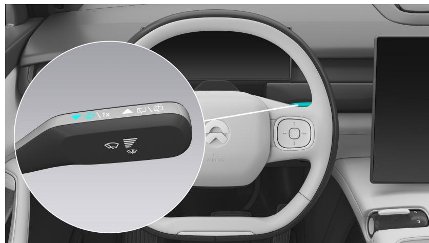
**Sprühen und Wischen:** Ziehen Sie den Wischerhebel nach hinten. Während der Hebel in dieser Stellung bleibt, sprühen die Wischedüsen Wasser und die Scheibenwischer wischen gleichzeitig langsam. Wenn Sie den Wischerhebel wieder loslassen, wird kein Wasser mehr versprüht. Die Scheibenwischer wischen anschließend noch drei Mal langsam, stoppen zwei Sekunden lang und wischen ein weiteres Mal.
