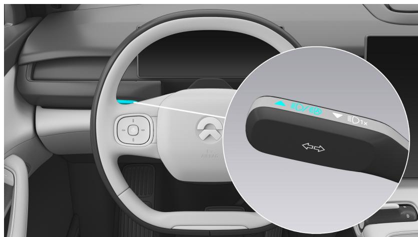
Wenn die Matrix-Fernlichtsteuerung ausgeschaltet ist, wechseln die Scheinwerfer bei Betätigen des Lichtbedienhebels nur zwischen Fern- und Abblendlicht.
