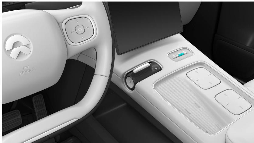
Drücken Sie die entsprechende Taste, um die Warnblinkanlage zu aktivieren. Alle Blinker des Fahrzeugs und die Blinkeranzeige des digitalen Kombiinstruments beginnen zu blinken. Drücken Sie die Taste erneut, um die Warnblinkanlage auszuschalten.
