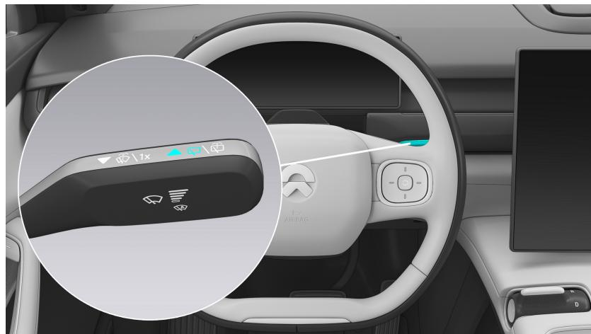
**Wischen mit Heckscheibenwischer:** Drücken Sie den Scheibenwischerhebel kurz nach vorne und lassen Sie ihn dann los, um die Heckscheibenwischer zu aktivieren oder zu deaktivieren.
