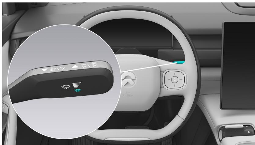
Drücken Sie den Wischerhebel nach unten, um die Frontwischerautomatik zu aktivieren. Im Kombiinstrument wird **Frontwischerautomatik aktiviert** angezeigt. Drücken Sie den Hebel nochmals nach unten, um die Funktion wieder auszuschalten. Im Kombiinstrument wird **Frontwischerautomatik deaktiviert** angezeigt.
