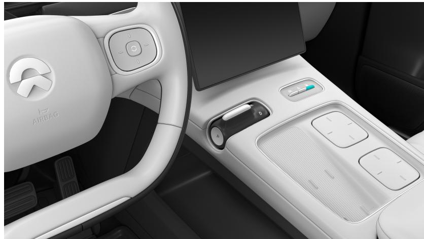
Wenn alle Türen des Fahrzeugs entriegelt und geschlossen sind, drücken Sie die Zentralverriegelungstaste an der Mittelkonsole, um das Fahrzeug zu verriegeln. Das Center-Display zeigt an, dass das Fahrzeug verriegelt ist. Die Kontrollleuchte der Taste leuchtet (grün).
