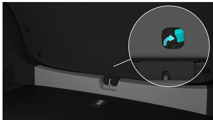
Öffnen Sie die quadratische Abdeckung über der Verriegelung von der Innenseite des Kofferraums aus und bewegen Sie dann mit Ihren Fingern den Knopf in der Vertiefung, um die Heckklappe zu öffnen.
