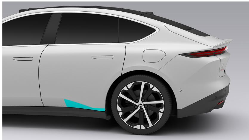
Zu beiden Seiten der Räder an der hinteren Karosserie befindet sich Steinschlagschutzfolie, die die Beschädigung der Karosserielackierung durch harte körnige Objekte wie Splitt beim schnellen Fahren wirksam verhindern kann.
