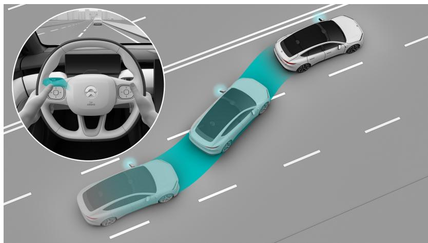
ALC ist für Autobahnen konzipiert. Die aktuelle und die Zielspur müssen gut beleuchtet sein, eindeutige Fahrbahnmarkierungen aufweisen und ausreichend Platz für einen sicheren Fahrbahnwechsel bieten.
