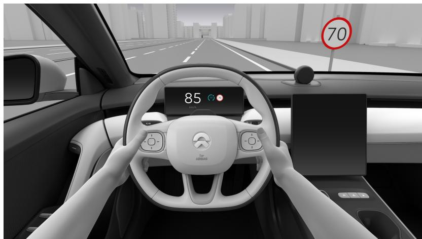
SLIF umfasst die Grundfunktionalität der Anzeige der aktuell gültigen Höchstgeschwindigkeit, sofern verfügbar, sowie die erweiterte Funktion der Identifizierung bedingter Höchstgeschwindigkeiten, sofern anwendbar.
