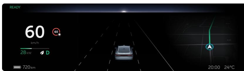
Die **SLIF Basic** gesetzliche Höchstgeschwindigkeit wird wie folgt visualisiert.
