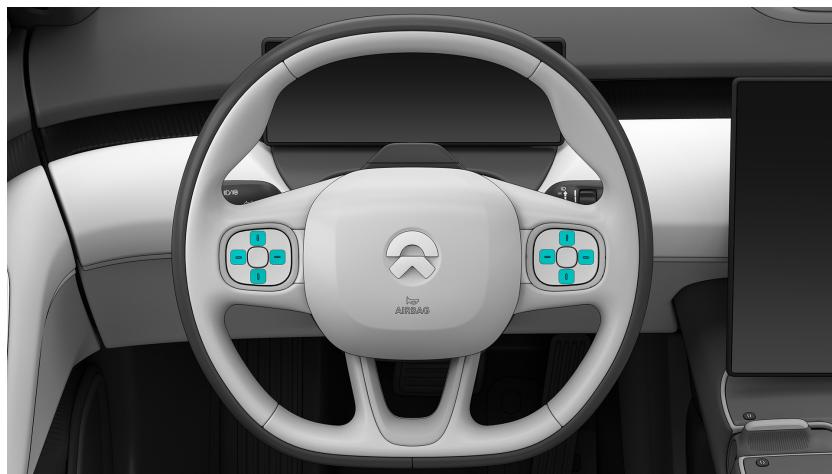
Öffnen Sie die Einstellungen unten im Center-Display, tippen Sie auf **Position anpassen > Seitenspiegel > Einstellung starten** und drücken Sie die Richtungstasten am Lenkrad, um den Winkel der Seitenspiegel in vier Richtungen einzustellen. Nach abgeschlossener Einstellung tippen Sie entweder auf **Einstellung beenden** warten Sie etwa 5 Sekunden lang, ohne die Einstelltasten am Lenkrad zu benutzen, damit das System den Einstellmodus automatisch beendet.
