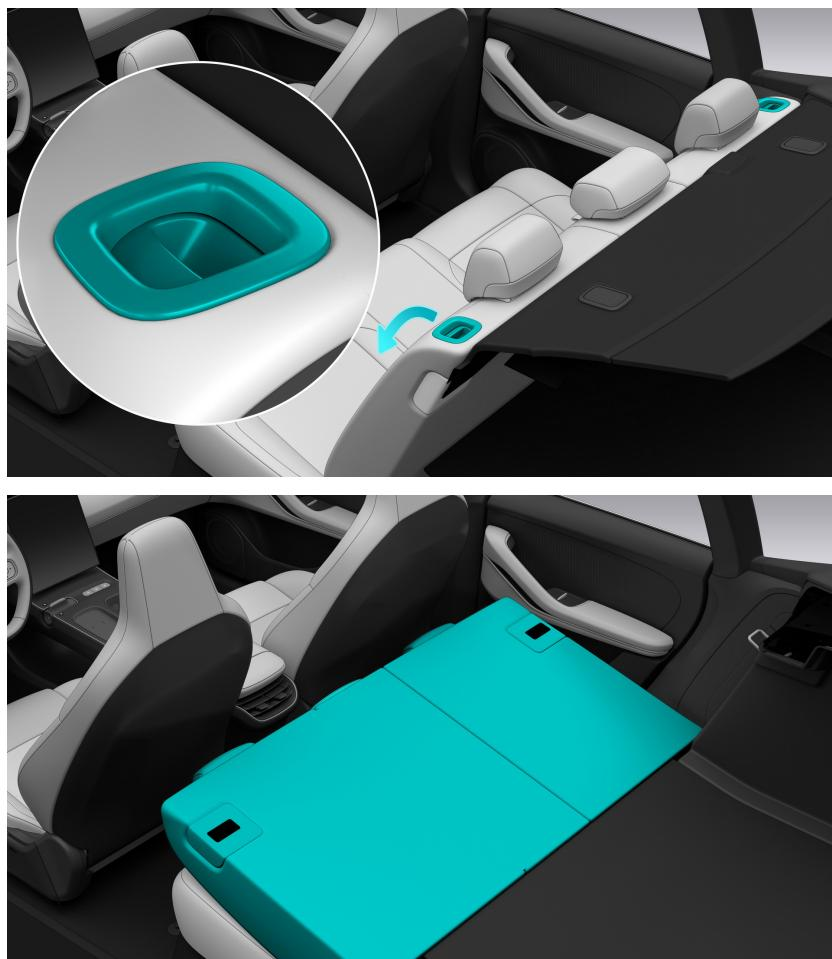
Ziehen Sie zum Entriegeln der Lehne am mechanischen Griff der Sitzlehne und drücken Sie dann die Lehne zum Verstellen der Sitzlehne nach vorn.
