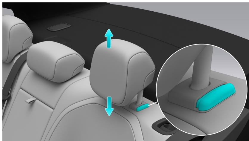
Drücken Sie zum Verstellen der Kopfstütze nach oben und unten auf den rechten Knopf unter der Kopfstütze. Bewegen Sie die Kopfstütze in eine der Raststellungen, bis sie hörbar einrastet. Daran erkennen Sie, dass die Kopfstütze in dieser Position fixiert ist.
