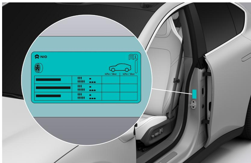
Ein hoher Reifendruck kann den Fahrkomfort beeinträchtigen und macht das Fahrzeug anfällig für Schäden durch Straßenunebenheiten. In schweren Fällen besteht sogar die Gefahr eines Reifenplatzers, der die Fahrzeugsicherheit gefährdet. Unzureichender Reifendruck kann zu ungleichmäßigem Reifenverschleiß führen, das Fahrverhalten beeinträchtigen und den Energieverbrauch des Fahrzeugs erhöhen.
