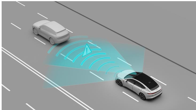
Das Frontalkollisionswarnsystem funktioniert bei Geschwindigkeiten von mehr als 4 km/h und ist nicht auf einen bestimmten Straßentyp beschränkt.
