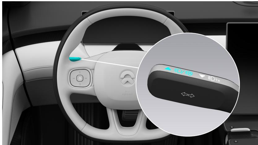
Wenn die Fernlichtautomatik ausgeschaltet ist, wechseln die Scheinwerfer beim Betätigen des Lichtbedienhebels nur zwischen Fern- und Abblendlicht.
