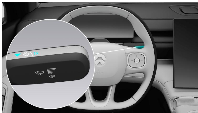
**Einmalige Wischbewegung:** Drücken Sie den Wischerhebel einmal nach hinten, um die Frontscheibenwischer einmal wischen zu lassen.
