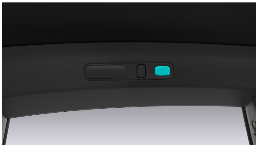
Wenn Sie das Fahrzeug von außen verriegeln (mit dem intelligenten Schlüssel oder der NIO-App), werden alle Innenraum-Leseleuchten gleichzeitig ausgeschaltet.
