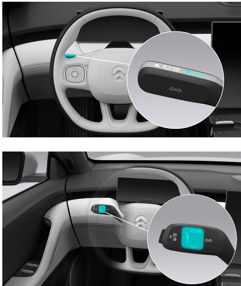
Um das Fernlicht nur einmal kurz aufzuleuchten zu lassen (Lichthupe), ziehen Sie den Lichtbedienhebel nach hinten und lassen ihn dann los.
