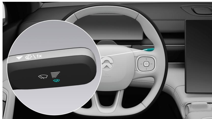
Drücken Sie den Wischerhebel einmal nach unten, um die Frontwischerautomatik zu aktivieren. Auf dem Display des Kombiinstruments wird **Frontwischerautomatik aktiviert** angezeigt. Drücken Sie den Hebel nochmals nach unten, um die Funktion wieder auszuschalten. Auf dem Display des Kombiinstruments wird **Frontwischerautomatik deaktiviert** angezeigt.
