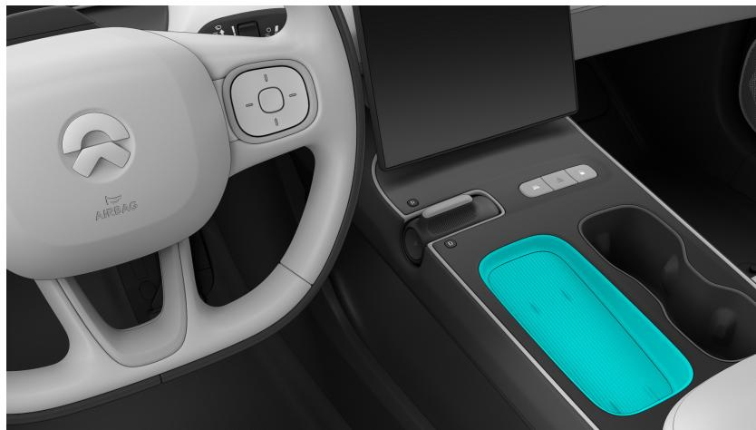
Die Funktion zum kabellosen Laden ist standardmäßig aktiviert. Zum Ausschalten der Funktion rufen Sie das kabellose Laden über die Statusleiste oben rechts im Center-Display auf. Die aktuelle Einstellung wird im Konto des Halters oder des autorisierten Benutzers gespeichert. Der aktuelle Ladestatus wird im Center-Display angezeigt.
