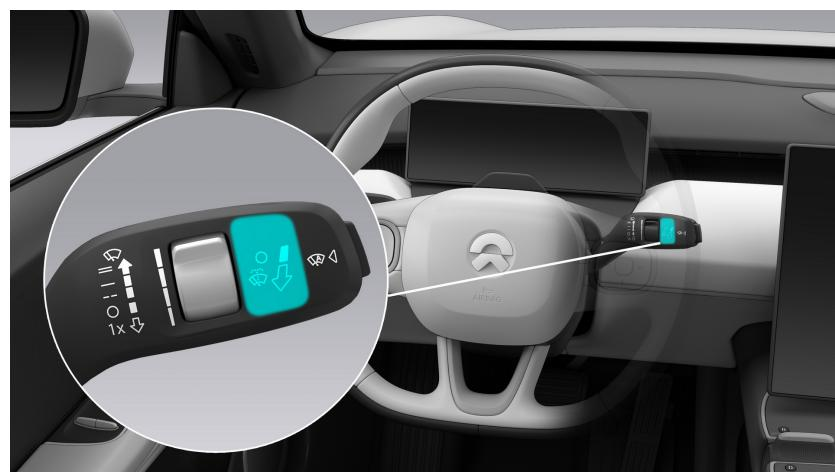
Ziehen Sie den Wischerhebel nach hinten. Wählen Sie
