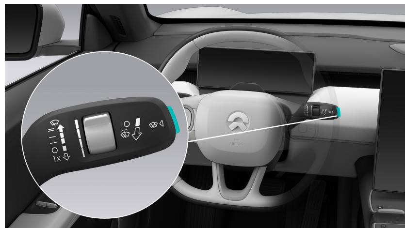
Drücken Sie zum Aktivieren der Wisch-Automatik auf die Taste „Automatisches Wischen“
