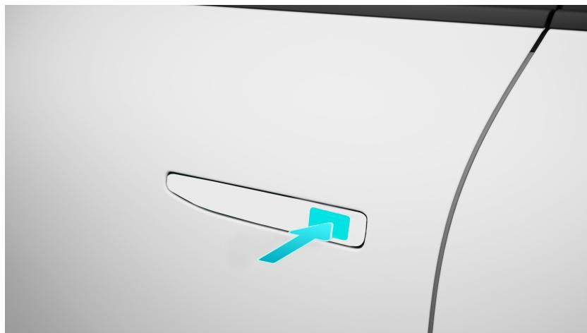
Wenn Sie den Schlüssel im Fahrzeug lassen oder eine Tür (einschließlich Motorhaube und Heckklappe) geöffnet ist, funktioniert die schlüssellose Verriegelung nicht, wenn Sie den Sensorbereich des Außengriffs berühren. Vor dem Verriegeln müssen Sie den Schlüssel aus dem Fahrzeug entfernen oder alle Türen schließen.
