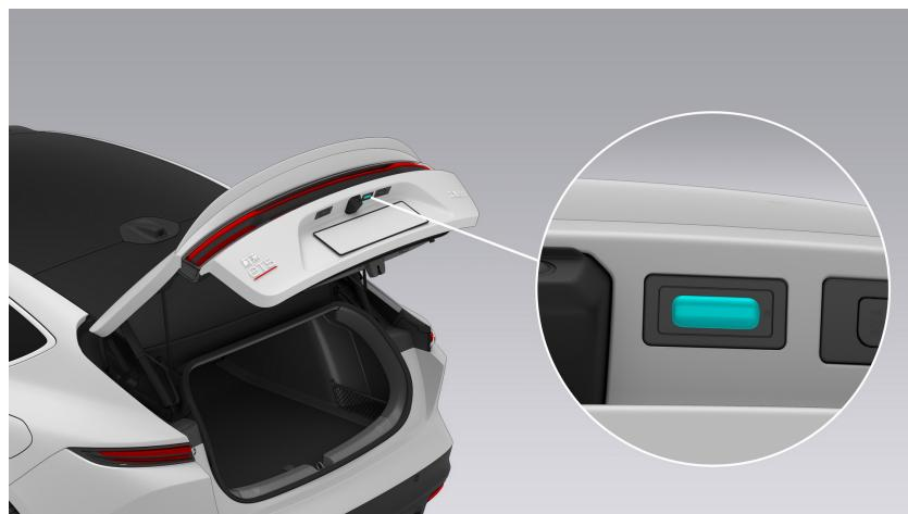
Wenn Sie den intelligenten Schlüssel mitführen, öffnet sich die Heckklappe automatisch, wenn Sie die entsprechende Taste drücken.
