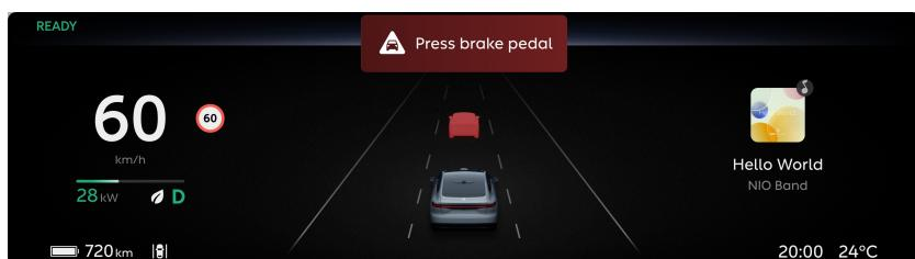
*Die Simulation der dynamischen Umgebung (ESD) zeigt eine visuelle Warnung an, wenn die Frontalkollisionswarnung ausgelöst wird. Die ESD dient nur zur Veranschaulichung und kann die tatsächlichen Verkehrsbedingungen nicht vollständig widerspiegeln.*
