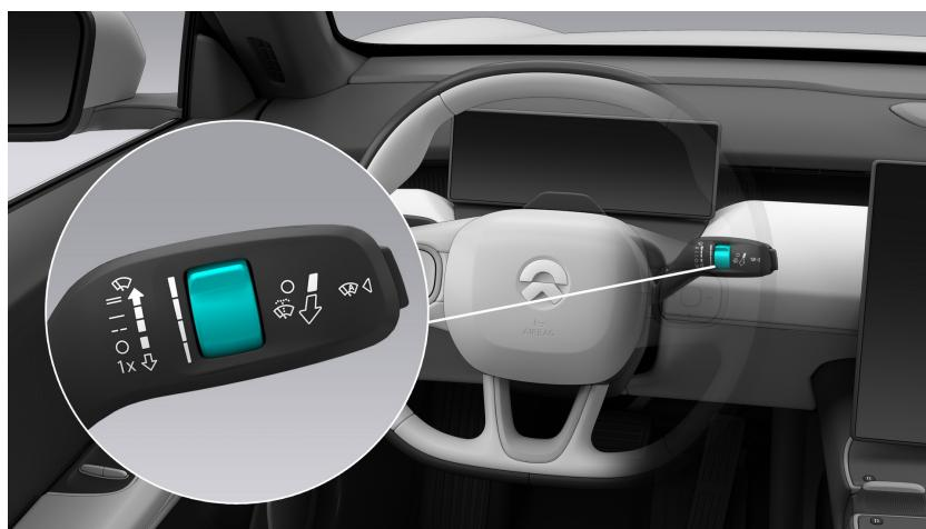
Wenn sich die Scheibenwischer im Modus „Sporadisches Wischen“ befinden, lässt sich die Wischgeschwindigkeit mit dem entsprechenden Schalter verstehen. Scrollen Sie zum Erhöhen/Verringern der Wischfrequenz nach oben bzw. unten.
