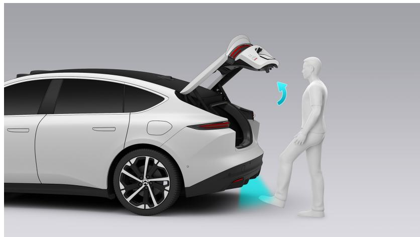
Um die Kicksensor-Funktion der Heckklappe zu aktivieren, öffnen Sie die Einstellungen unten im Center-Display und tippen Sie auf **Verriegelung von Türen und Fenstern > Kicksensor**.
