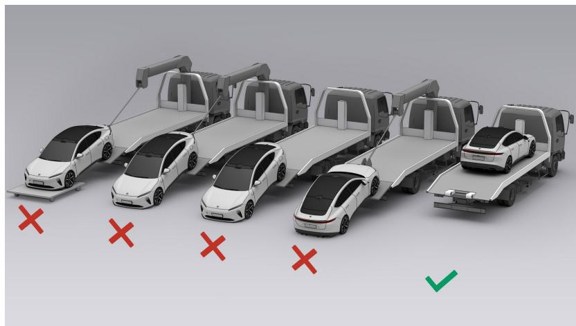
Wenn das Fahrzeug abgeschleppt werden muss, fordern Sie bitte einen Abschleppwagen mit Plattform zum Transport des Fahrzeugs an. Abschleppen des Fahrzeugs:
